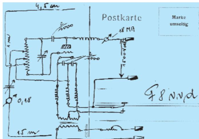
Rückseite der QSL-Karte von K4SAR (Vorderseite siehe CQ DL 1/98, S. 75 oben) mit dem Schaltbild des von OM Julius Kron in Saarbrücken benutzten Selbstbau-Senders. Die Anode der Senderöhre wird mit 1500 V versorgt, das Instrument maß 0,018 A Strom, auf der Vorderseite der QSL werden 17 W Sendeleistung ange-
