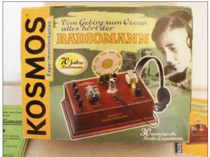
2004: RADIOMANN, 70 Jahre-Jubiläumsauflage (30 Experimente mit Doppeltriode 12AU7/ECC82)
