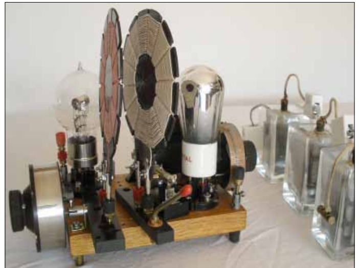
1924: Audion-RX mit NF-Stufe aus Bauteilen des Vorläufer-Baukastens von 1920 (Schema für Mittel- und Langwelle: s. Seite 42)
