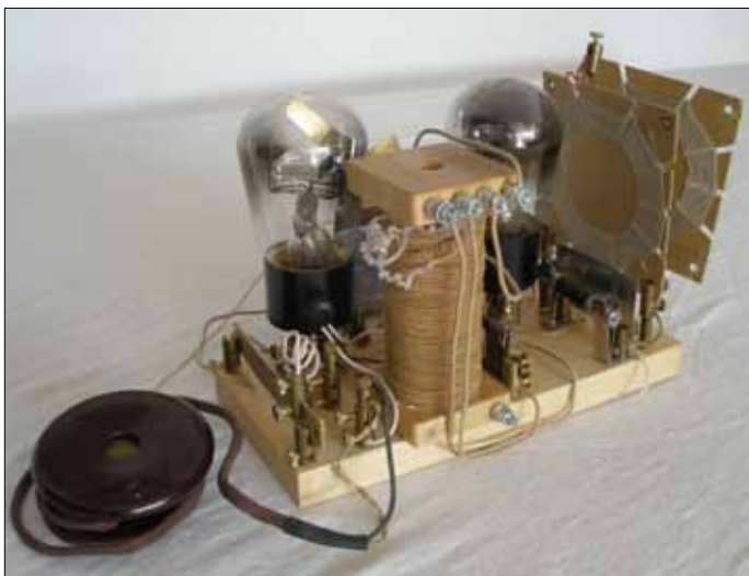
1930: ähnlich 1924, jedoch mit neueren Bauteilen, 2x RE074d/DM300
