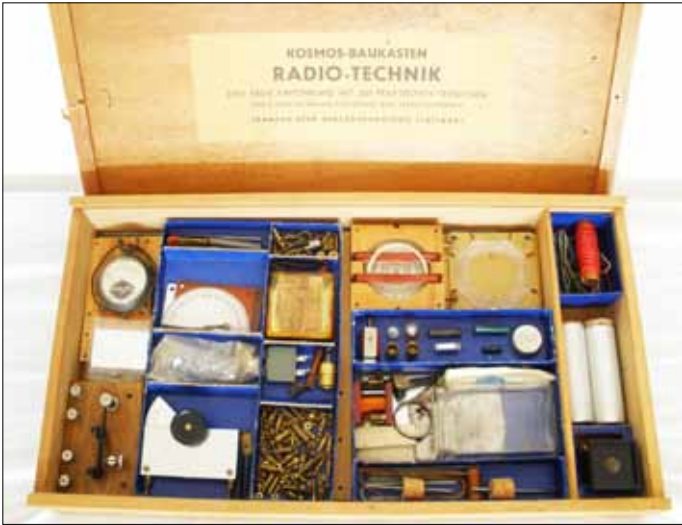
1951: RADIO-TECHNIK, 5. Auflage mit 3 Röhren DM300 (382 Versuche)
